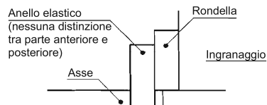
B Dettaglio dell'installazione dell'anello elastico
